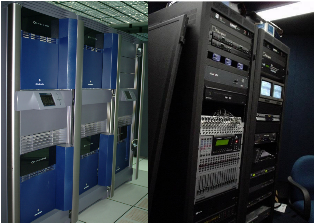
Figura 5. (a) Supercomputadora gráfica Onyx 350 ubicada en un entorno de clima controlado dentro de la DGSCA. (b) Rack al interior de la cabina de la sala IXTLI, que alberga los controles del sistema de sonido y fuentes de video alternas como DVD y VHS entre otros.
